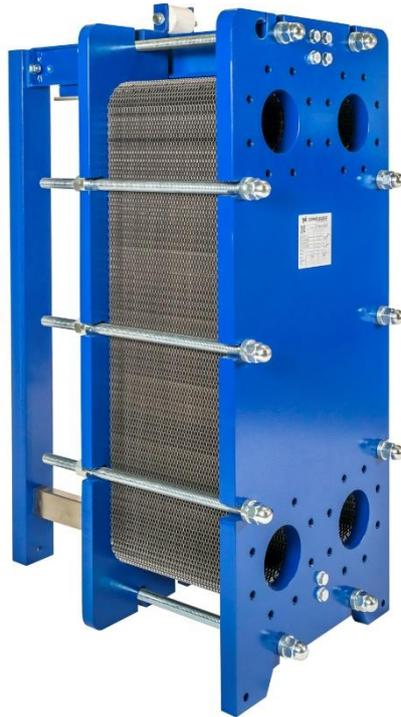
Lo scambiatore di calore a piastre è un elemento modulare, costituito da un pacco di piastre corrugate che consentono ai fluidi primario e secondario di scambiare il calore tra loro, contenuto in un telaio costituito da due piastroni tenuti insieme da un certo numero di tiranti.
